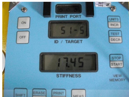
Gambar 3.10 Hasil uji pertama dengan GeoGauge pada box 2
