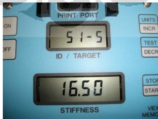
Gambar 3.15 Hasil uji ketiga dengan GeoGauge pada box 3
