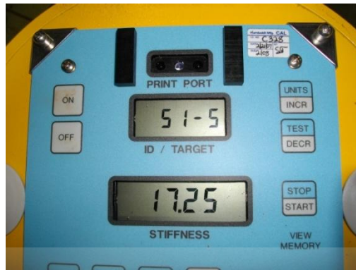
Gambar 3.8 Hasil uji kedua dengan GeoGauge pada box 1
