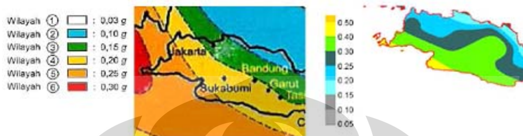
Gambar 3.2 Perbedaan peta spektra percepatan gempa antara SNI 03-1726-2002 (kiri) dengan usulan Irsyam dkk. (kanan) untuk periode ulang gempa 475 tahunan daerah Jawa Barat
