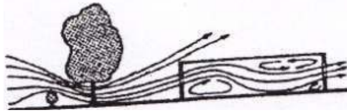
Gambar 2.16. Ilustrasi Aliran Udara yang Dipengaruhi Tanaman Pagar dengan Ketinggian 1 m dan Ditempatkan 10 m dari Bangunan serta Pohon yang Ditempatkan pada jarak 6 m dari Bangunan (Boutet, 1987)
