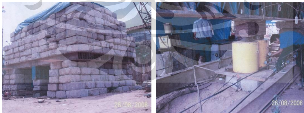
Gambar 4.7b. Pelaksanaan Uji Beban Statik. Kiri: Beban Uji Kentledge Telah Siap; Kanan: Persiapan Jack dan Dial Gauge (dari Dokumentasi pengujian TP-03/BP 16)*
