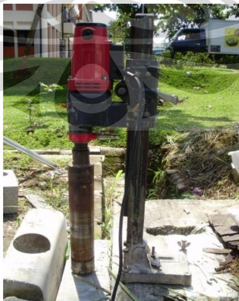
**Gambar 3.8** Mesin Bor untuk *Coring*
