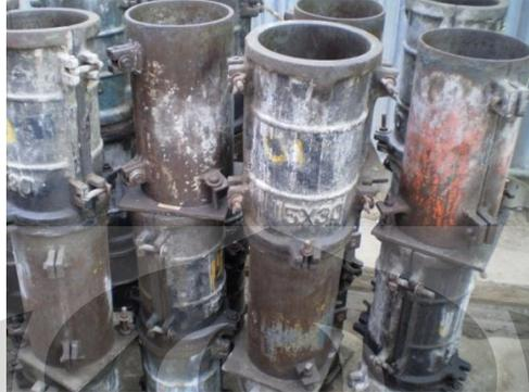
a. Cetakan Silinder (Diameter=15cm, Tinggi=30cm)
