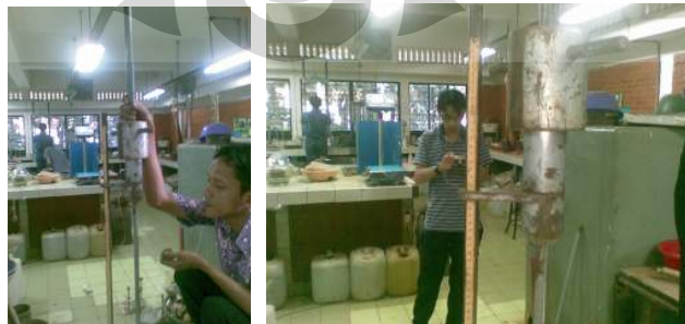
Gambar 4.5 Pengujian DCP di laboratorium
