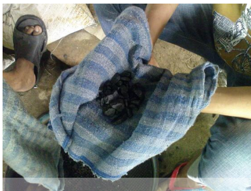
Gambar 4. 6 Proses pengeringan permukaan agregat kasar untuk mendapatkan kondisi SSD pada pengujian berat jenis dan penyerapan
