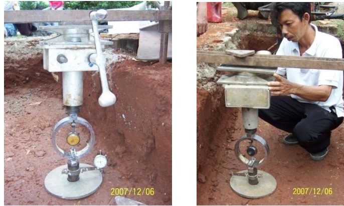
Gambar 4.7. Alat ukur dan pengukuran CBR lapangan
