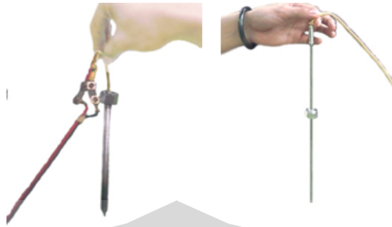
Gambar 3.8 Termokopel Type K Ketahanan Temperatur Maksimum 1000 °C
