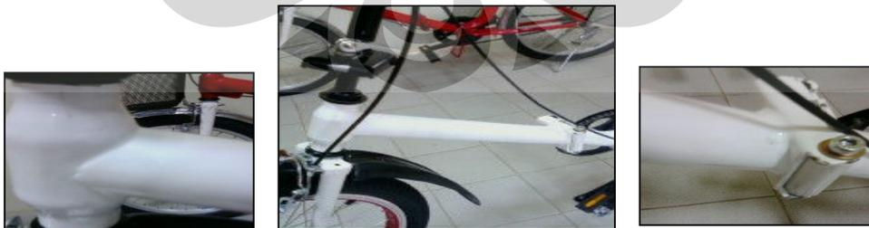
Gambar 1.6 Batang depan dan engsel dari rangka sepeda lipat
