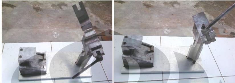
Gambar 3.64 Jig dalam kondisi clamper terbuka dan tertutup
