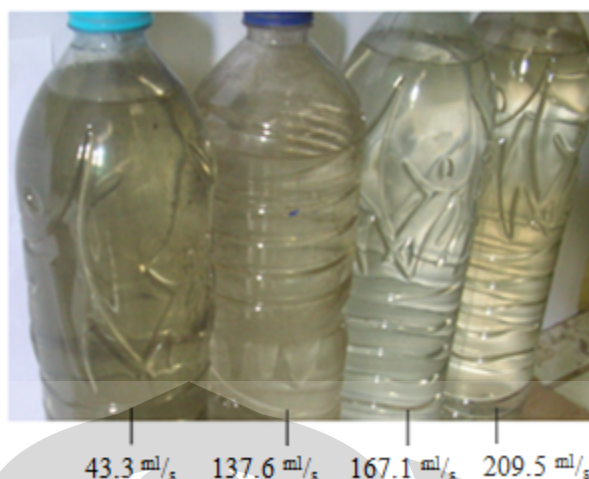
Gambar 4.4.1.2 Perbandingan warna tar pada bukaan katub reservoir utama 30°
