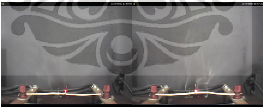
Gambar 4.7 Visualisasi asap pada awal munculnya (diambil pada detik ke-77) dengan arus 15A (sebelah kiri) dan 16 A (sebelah kanan)
