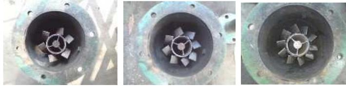
**Gambar 3.7** 1)Gas burner dengan 6 blade ; 2)Gas burner dengan 8 blade ; 3)Gas burner dengan 10 blade
