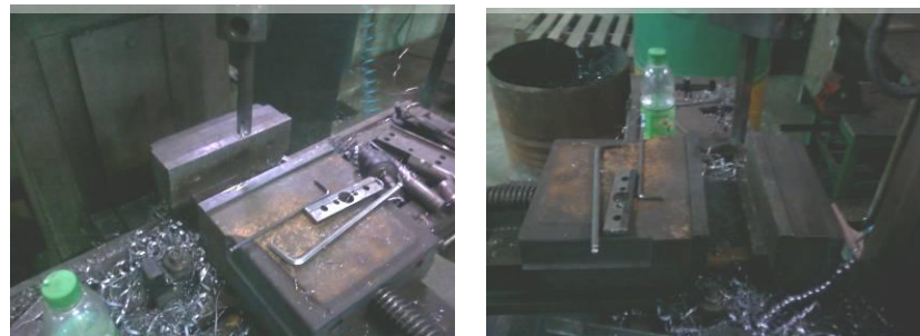
Gambar 4. 3. Ragum pemegang benda kerja
