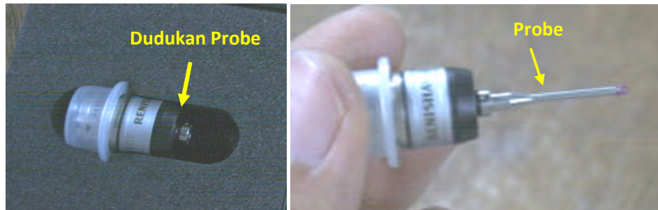
Gambar 5.2. Probe dipasang pada dudukannya
