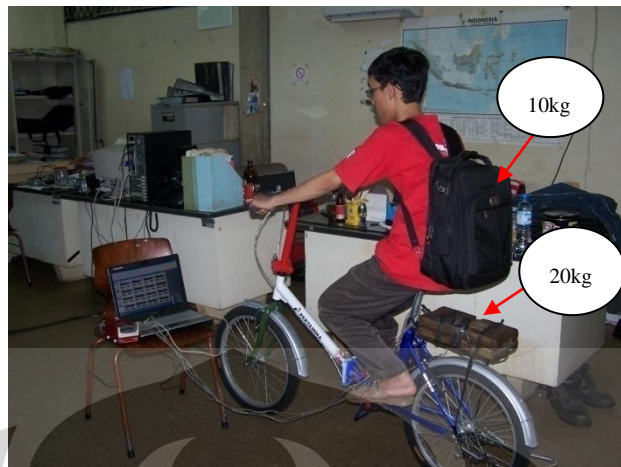
Gambar 3. 14. Pembebanan Sebelum Pengujian
