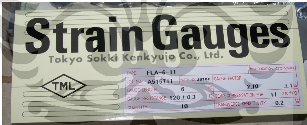
Gambar 3. 5. Jenis Strain Gage yang Digunakan
