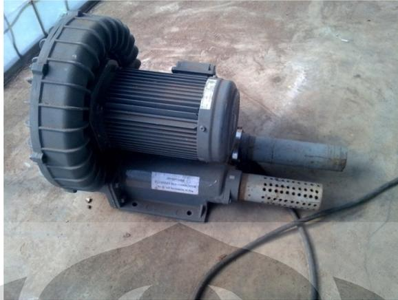
Gambar 3.12 Ring Blower pada Fluidized Bed Combustor UI
