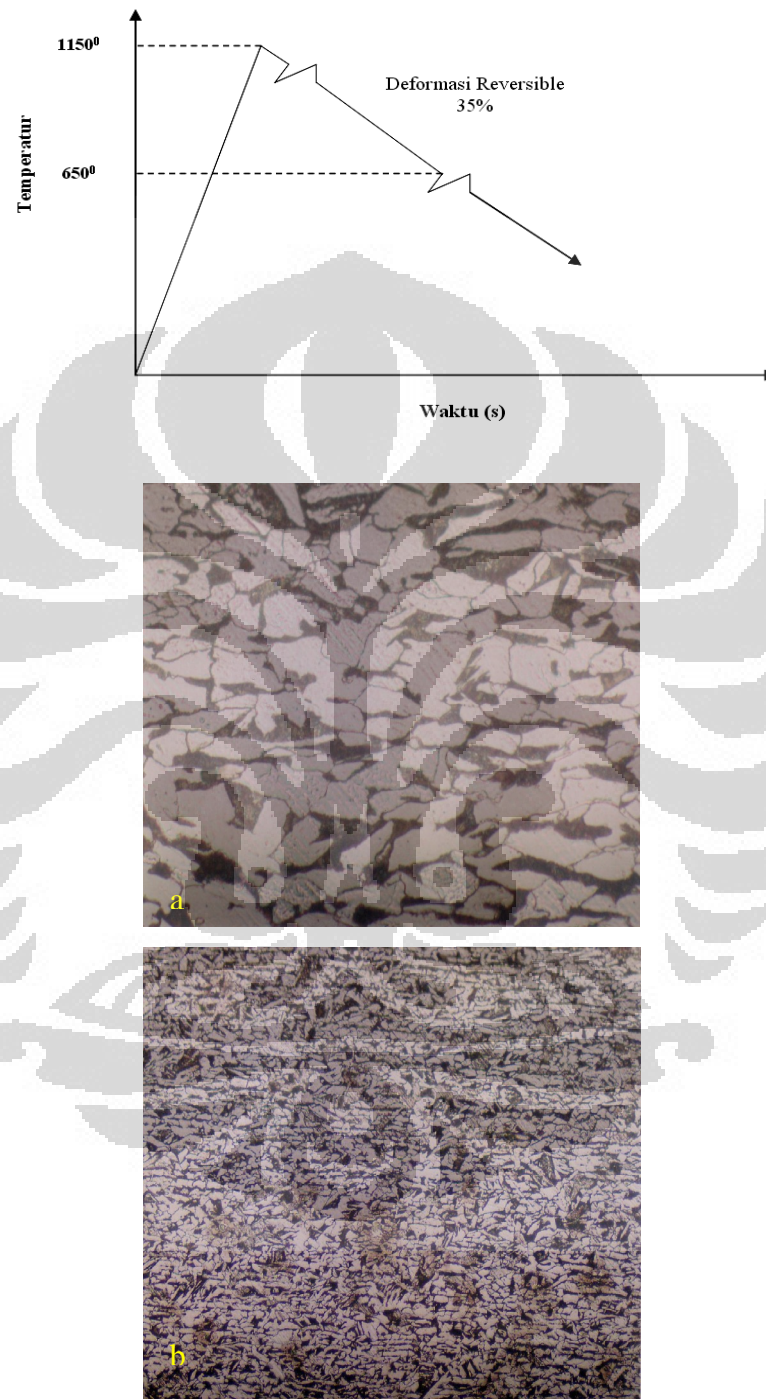
Gambar 4. 3. Foto struktur mikro ferit baja karbon rendah perlakuan proses C, etsa Nital 2%. (a) perbesaran 500 x ; (b) perbesaran 100 x
