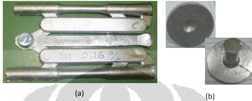
Gambar 3.8 Hasil coran (a) Sampel uji tarik, (b) Sampel uji komposisi
