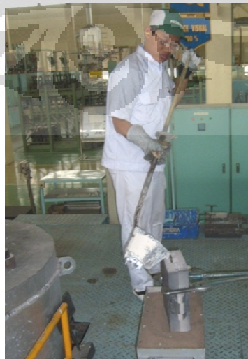
Gambar 3.7 Proses penuangan ke dalam cetakan uji tarik
