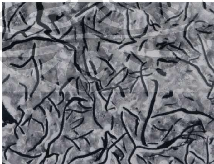
Gambar 2.11 Korosi pelarutan selektif [21] .
