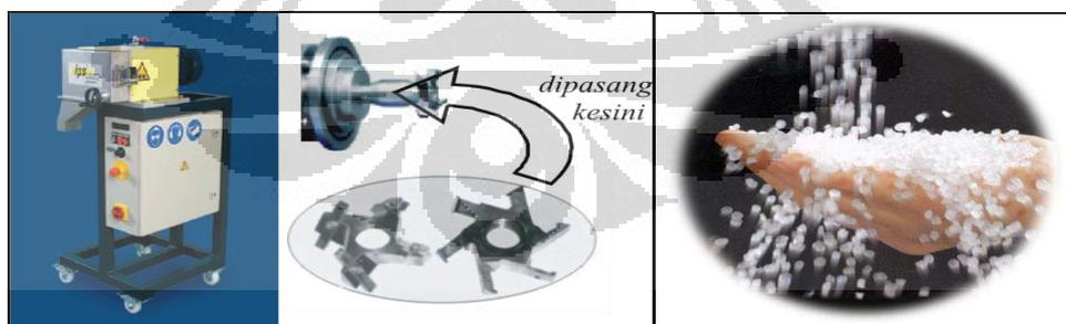
**Gambar 2.15** *Strand Pelletizer*, *Rotary Blade*, dan *Pellet Polymer* (dari kiri ke kanan)[6]
