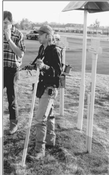
Gambar 2.11. Peralatan CIPS dan operator survei di lapangan
