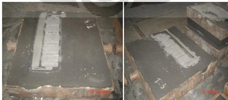
Gambar 3.7 Satu set cetakan untuk model (T3)
