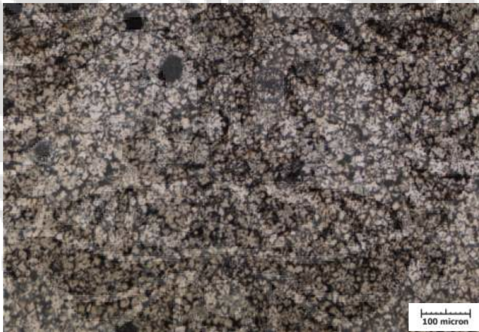
Gambar 4.6 Struktur Mikro Sampel 1 Paduan CZT Perbesaran 100 X
