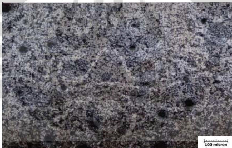
Gambar 4.8 Struktur Mikro Sampel 2 Paduan CZT Perbesaran 100 X
