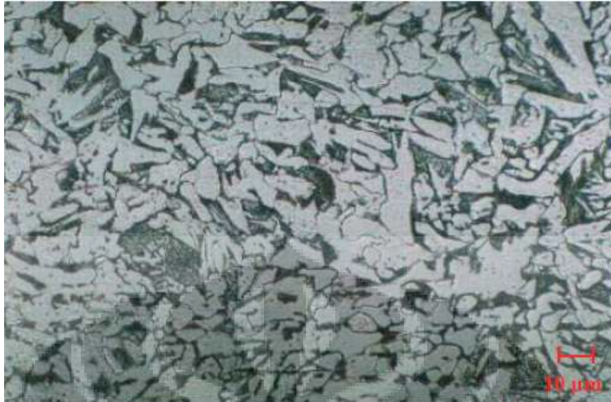
Gambar 4.4 Foto mikrostruktur sampel seamless dengan perbesaran 500x; etsa nital 2%
