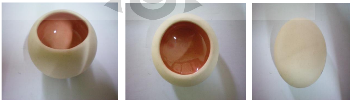
Gambar 3.5 Wadah yang digunakan untuk membuat pack aluminide
