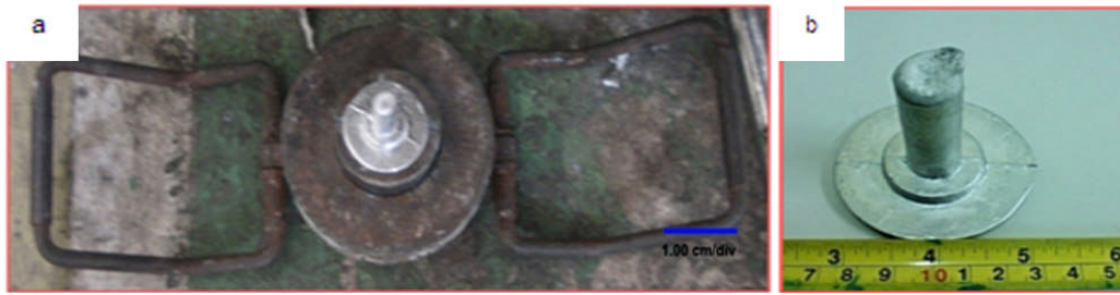
Gambar 3.8 (a) Alat uji komposisi dan (b) Sampel uji komposisi kimia [15]
