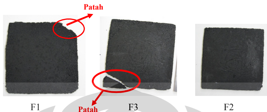
Gambar 4.5 Patahan sampel bagian siku F1 dan F3
