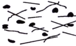
Gambar 2.27 Komposit hibrida serat-partikulat ( fiber-particulate hybrids ). [20]
