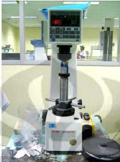
Gambar 3.15 Alat uji kekerasan Rockwell B.
