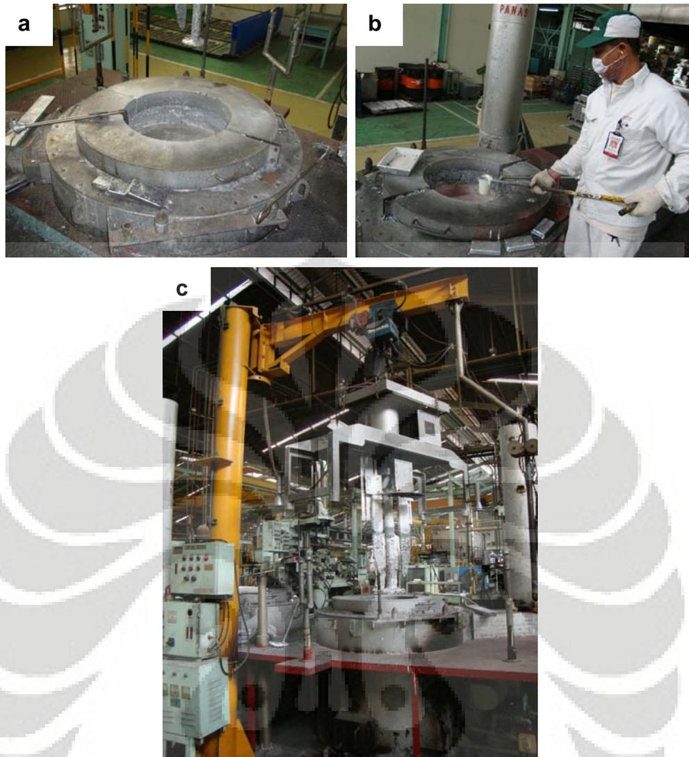
**Gambar 3.8** (a) *Crucible furnace*, (b) Pemasukan penghalus butir dan unsur modifikasi ke dalam *crucible furnace*, (c) Proses *degassing* dengan mesin GBF.
