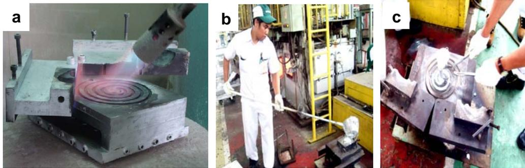
**Gambar 3.13** (a) *Preheating* pada cetakan uji fluiditas, (b) Proses penuangan aluminium cair ke cetakan uji fluiditas, (c) Proses pengeluaran sampel dari cetakan.
