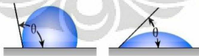
Gambar 2. 10. Sudut Kontak. (a) >90^\circ , (b) <90^\circ [28]
