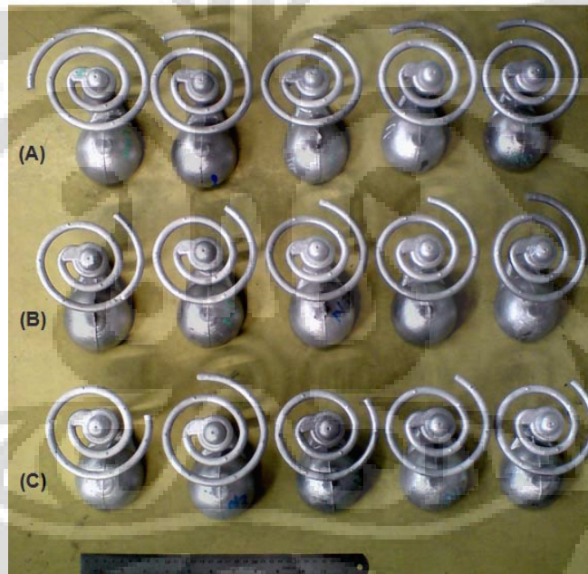
Gambar 4.11 Perbandingan nilai fluiditas paduan AC4B komposisi 0.120 wt. % Ti dan 0.018 wt. % Sr pada pengamatan; (a) 0 menit; (b) 60 menit dan; (c) 120 menit.
