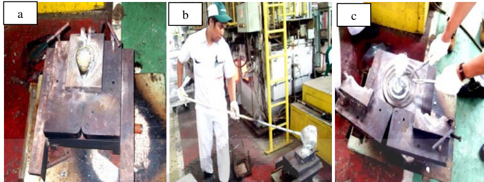
Gambar 3.17 a) Proses penuangan aluminium cair ke cetakan uji fluiditas, b) cetakan uji fluiditas, dan c) proses pengeluaran sampel dari cetakan.
