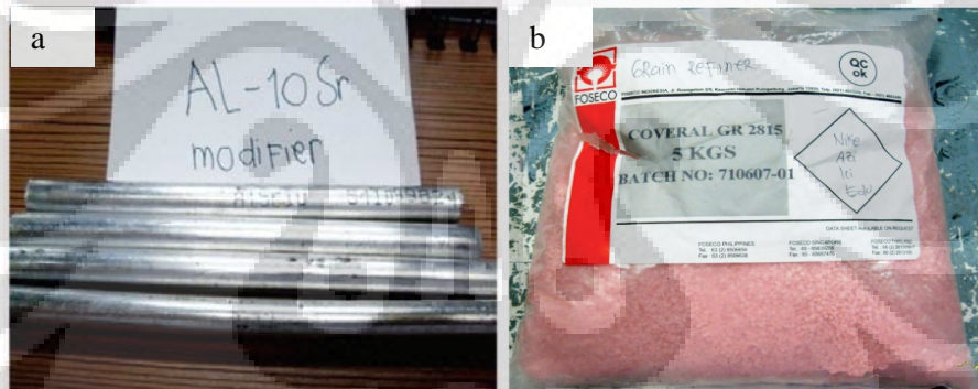
Gambar 3.5 Elemen yang akan ditambahkan a) master alloy Al-10Sr , b) penghalus butir flux Coveral GR-2815.
