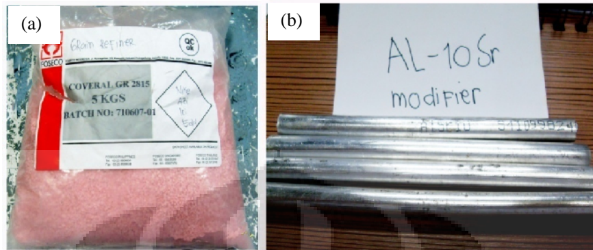
Gambar 3. 5 Elemen yang akan ditambahkan (a) master alloy Al-10Sr , (b) penghalus butir flux Coveral GR 2815 ® .
