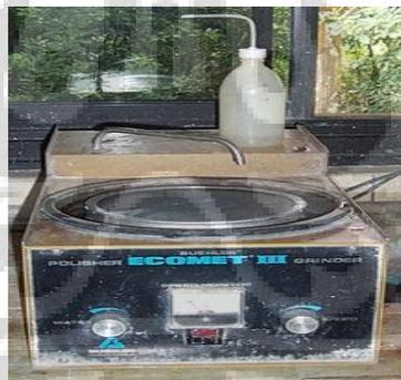
**Gambar 3.9** Mesin Amplas.
