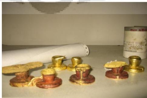
**Gambar 3.6** Bentuk sampel pengujian komposisi kimia dengan *spectrometer*.
