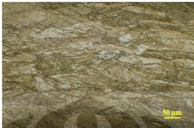
**Gambar 4.1** Menunjukkan butir pipih pada posisi samping. Perbesaran 200X. Etsa  $\text{FeCl}_3$ .
