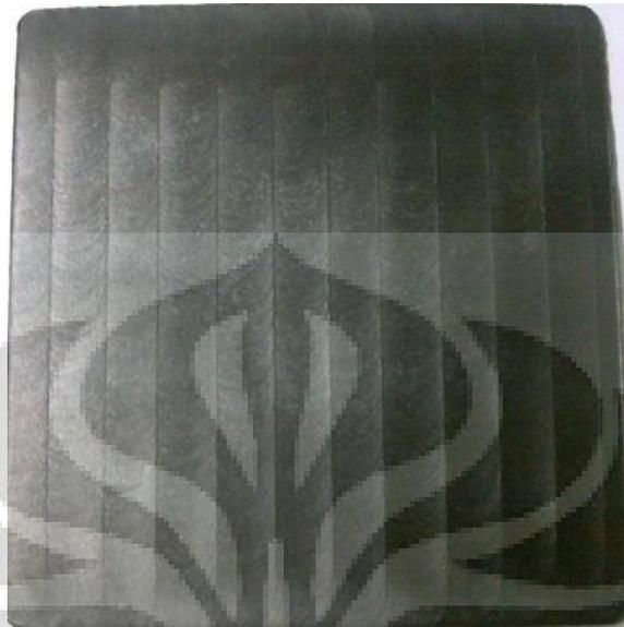
**Gambar 4.4.** Pelat Bipolar 3 dengan Penambahan *Polyaniline* 150 mg
