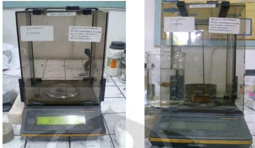
**Gambar 3.11.** Penimbangan sampel di udara (kiri) dan di air (kanan)
