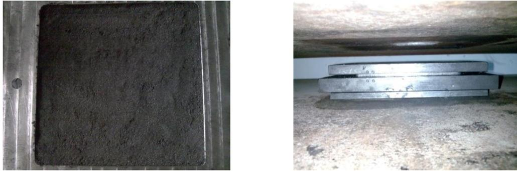
**Gambar 3.4.** Hasil *Mixing* dalam Cetakan (Kiri) dan Penempatan di Mesin *hot press* (Kanan)
