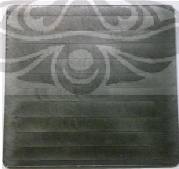
**Gambar 4.5.** Pelat Bipolar 4 dengan Penambahan *Polyaniline* 200 mg
