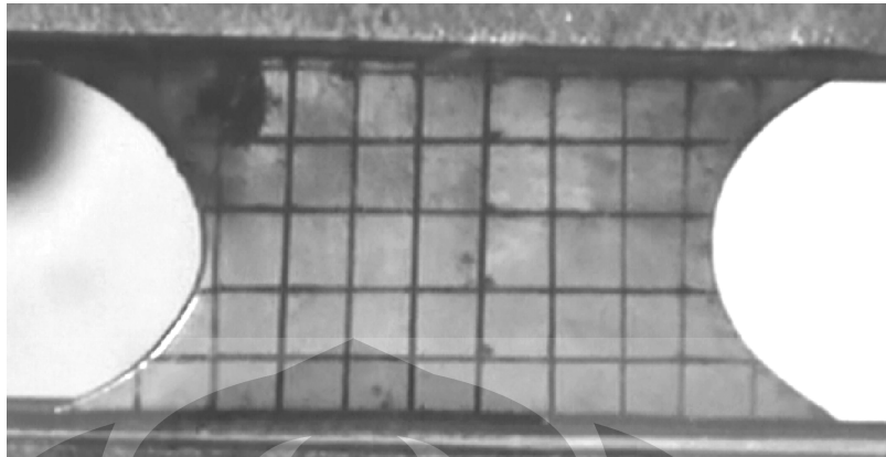
Gambar 4.5 spesimen A pada saat 1,15 yield .
