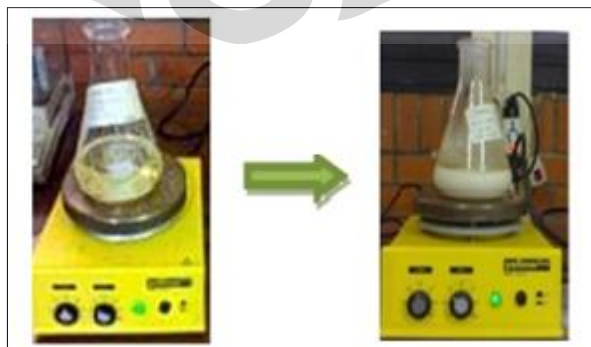
Gambar 3.2. Proses pelapisan Al 2 O 3
