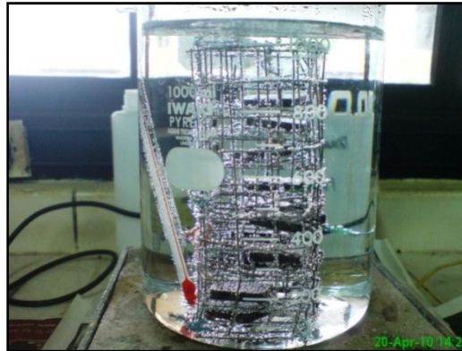
Gambar 3.9 Sampel Dipanaskan dalam Air pada T=100^{\circ}\text{C}
