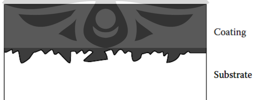
Gambar 2.5 Skema Mechanical Bonding Antara Coating Dengan Substrat[3]
