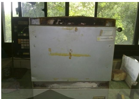
Gambar 3.7 Dapur Naberterm Untuk Mendapatkan Temperatur Tinggi pada Penelitian
