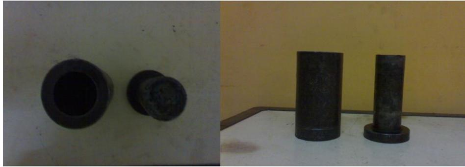
**Gambar 3.6** Cetakan material komposit graffiti-*coal tar pitch*
