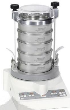
**Gambar 3.3** Mesin Pengguncang pada proses pengayakan
