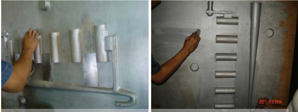
Gambar 3.3. (a) Pencocokan ukuran pola logam pada pola kayu. (b) Pola dioleskan dengan larutan separasi.
