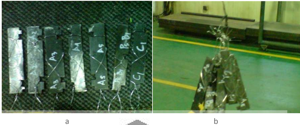
Gambar 4.1. (a) Sampel TWDI yang telah dililitkan kawat dan siap dilakukan proses austempering. (b) Kondisi penempatan sampel di dalam tungku selama proses austempering..
