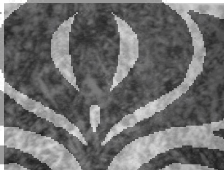
Gambar 2.14. Struktur Mikro Martensit Temper Baja 1050 Hasil Quench Air dengan Temperatur Temper 595° C. Perbesaran 825x [14]
