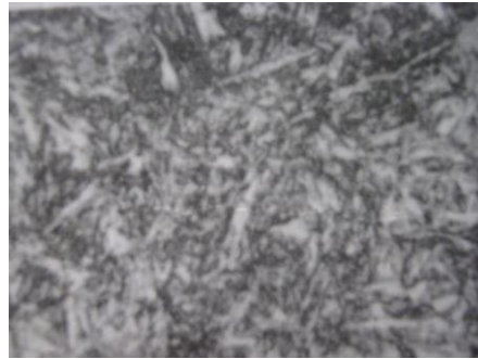
Gambar 2.13. Struktur Mikro Martensit Temper Baja 1050 Hasil Quench Air dengan Temperatur Temper 480° C. Perbesaran 825x [14]
