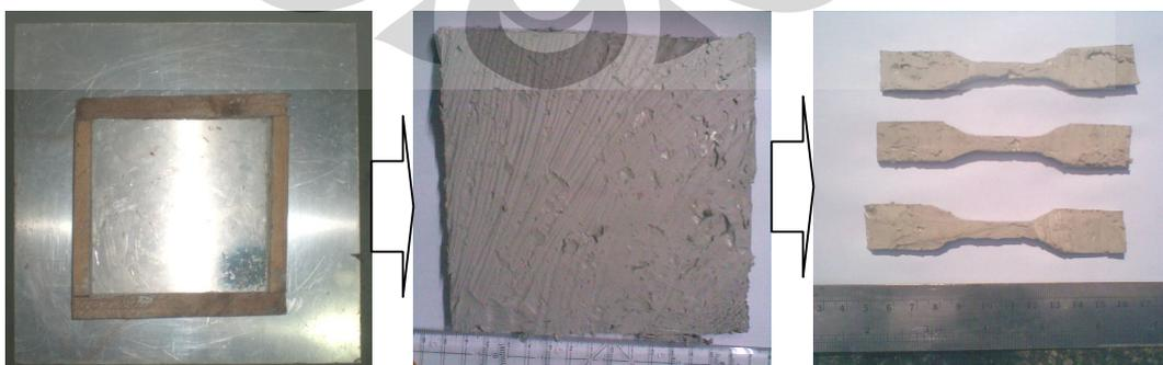
Gambar 3.27. Tahap pembuatan sampel pengujian tarik adhesif (a) pembuatan cetakan, (b) lembaran adhesif hasil cetakan dan (c) sampel pengujian tarik adhesif
