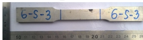
Gambar 3.17. Penandaan gage length pada sampel uji tarik pelat AA 6061 T-651 (a) 6-S-1, (b) 6-S-2, (c) 6-S-3.
