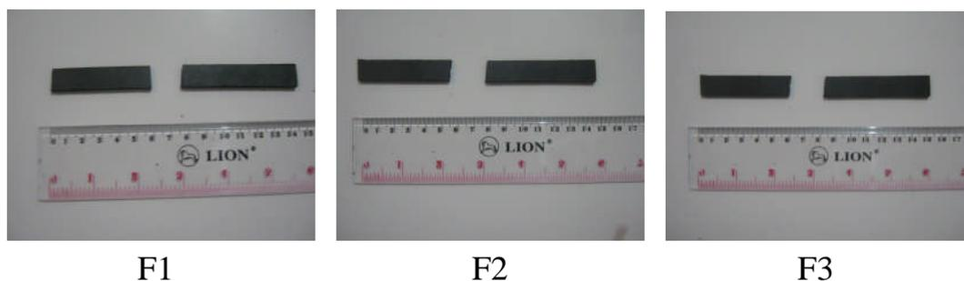
**Gambar 5.7.** Patahan Pelat Bipolar Hasil Pengujian Tarik
