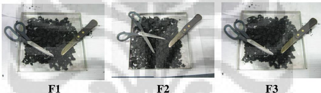
**Gambar 4.2.** *Master Batch* Hasil Proses Pencampuran Panas (*Hot Blending*)
