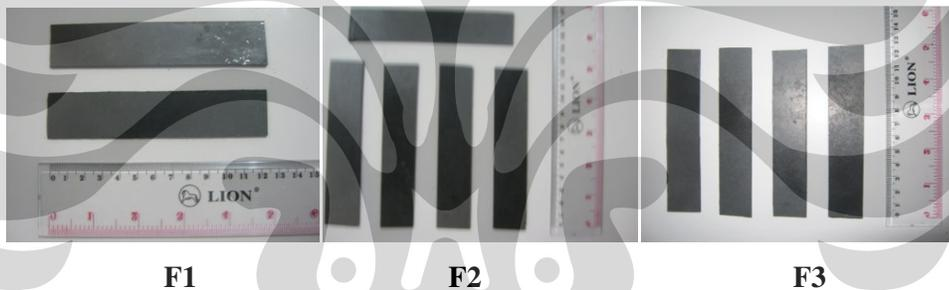
Gambar 4.5. Spesimen Pengujian Tekuk Pelat Bipolar ASTM D790
