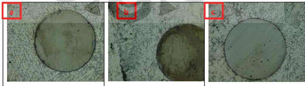
Gambar 4.10. Perbandingan sifat antarmuka antar sampel berdasarkan variasi penambahan Mg perbesaran 100x (a) 0,01% Mg, (b) 0,79% Mg, (c) 1,03% Mg
