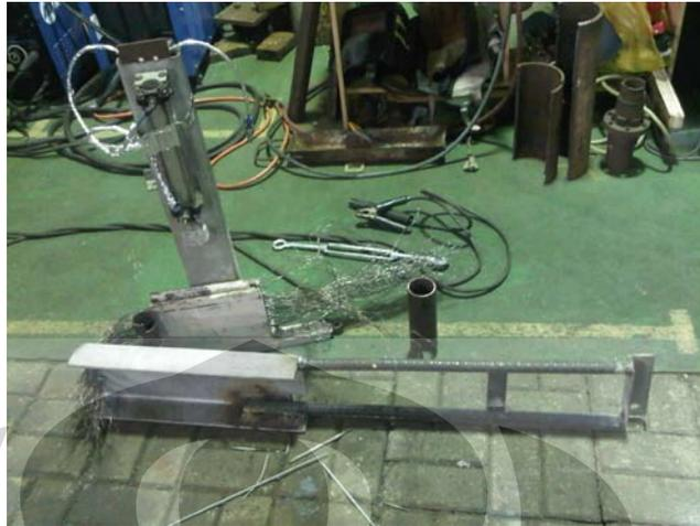
**Gambar 3.3. Gambar cetakan yang telah terpasang kawat yang sudah dikencangkan**
