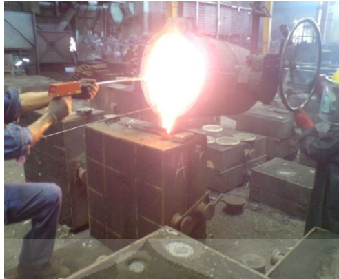
Gambar 3.8 Penuangan logam cair
