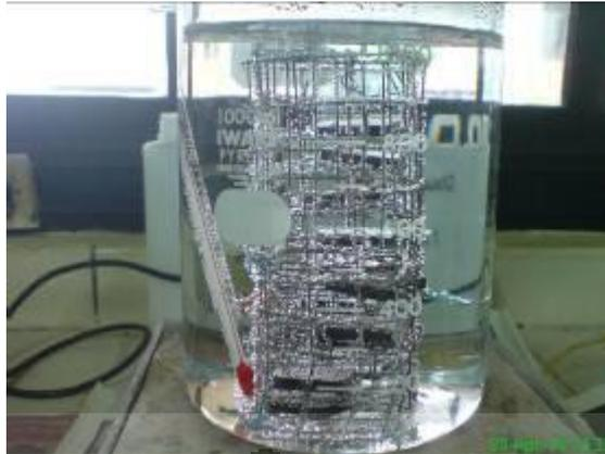
Gambar 3.9 Proses Perebusan Spesimen
