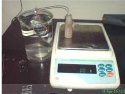
Gambar 3.8 Proses Pangukuran Massa dalam Air
